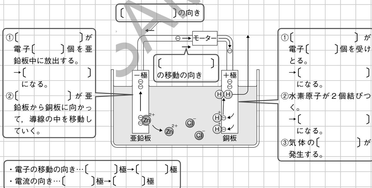
(6) ダニエル電池…金属板には〔 〕板と〔 〕板を、水溶液には〔 〕水溶液と〔 〕水溶液を用いた電池。2種類の水溶液の間は〔 〕などで区切られている。
